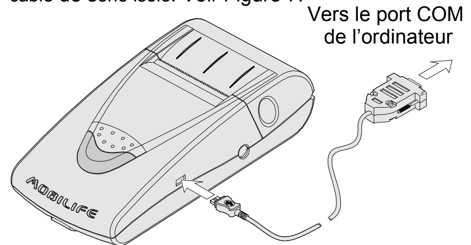
Figure 7. Liaison par câble série RS 232
