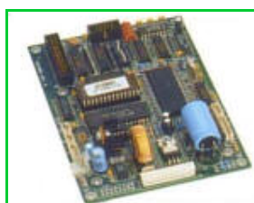
Carte de contrôle alimentation unique 12V, Centronics et RS232C
